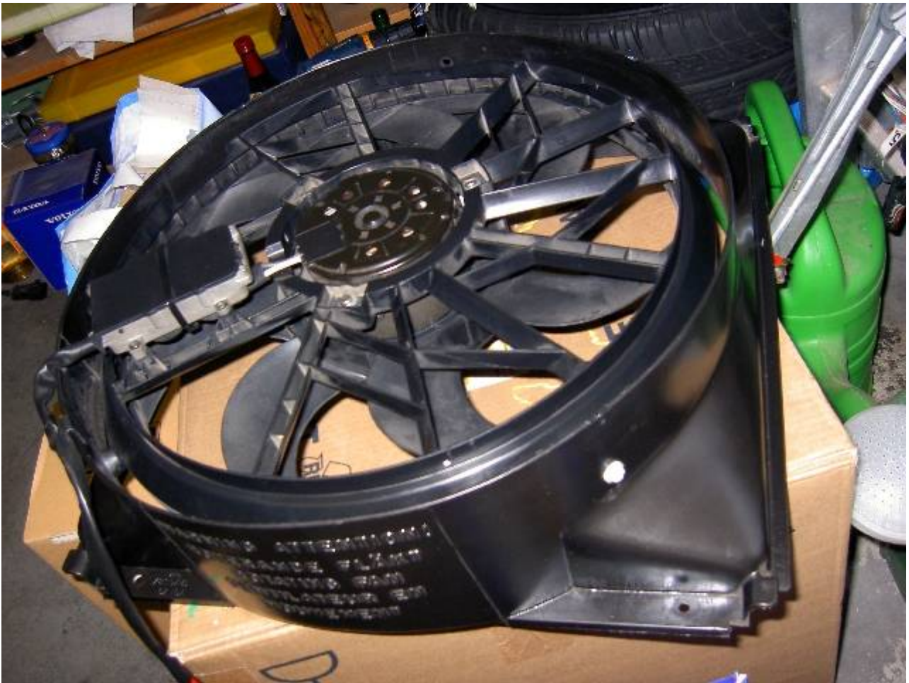
Die "alte" originale Zarge außm 940'er mit dem neuen Lüfter
