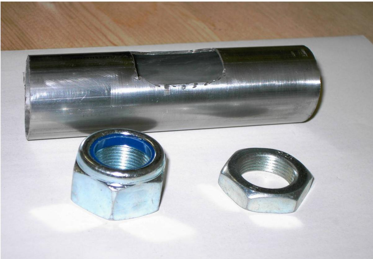
Edelstahlrohr nach dem Ausschnitt für den Kühlwasserschlauch, ich habe die kleine Mutter verbaut
