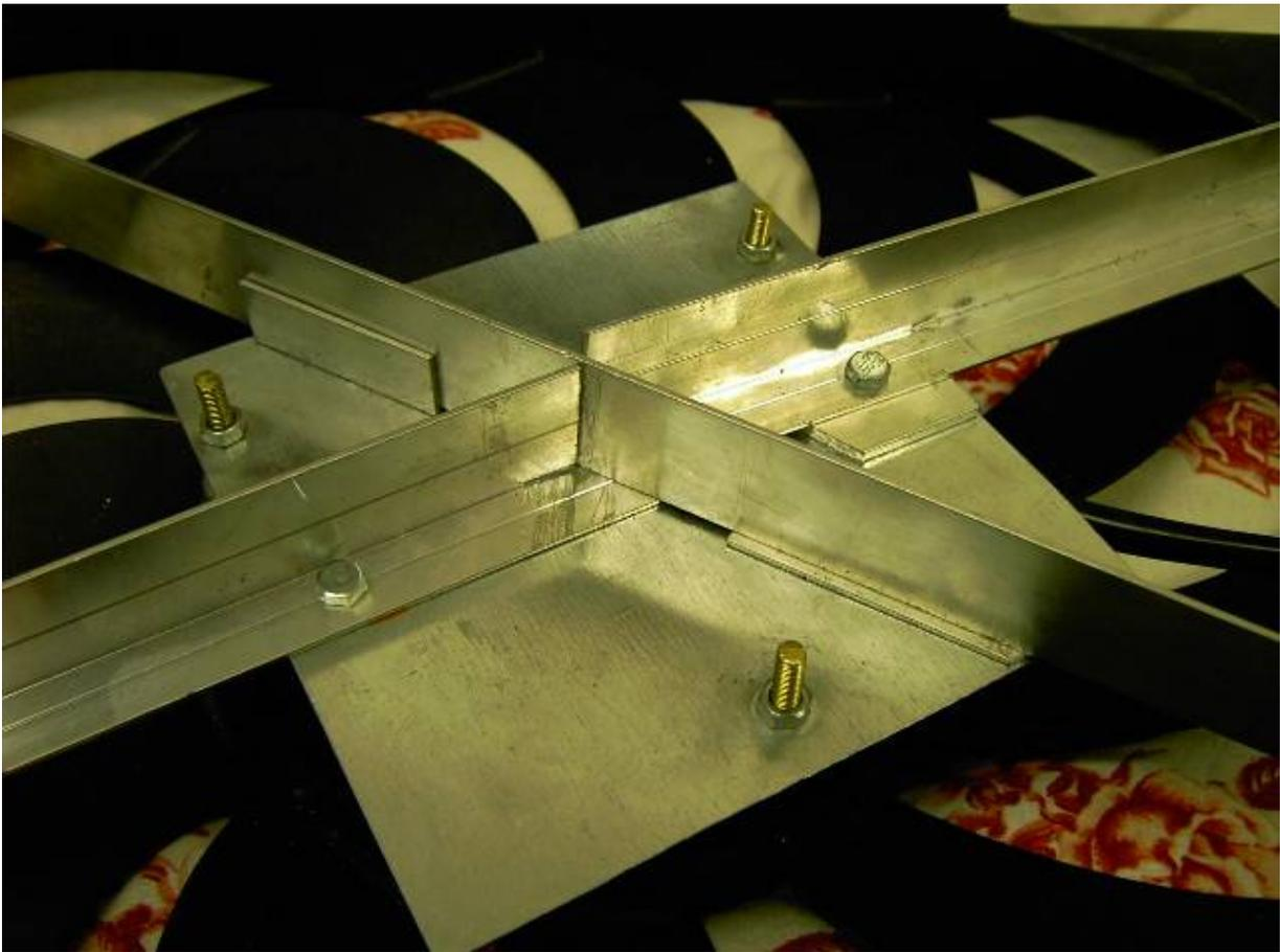
Eine durchgehende und eine zerteile Querstrebe, beide auf der Platte verschraubt
