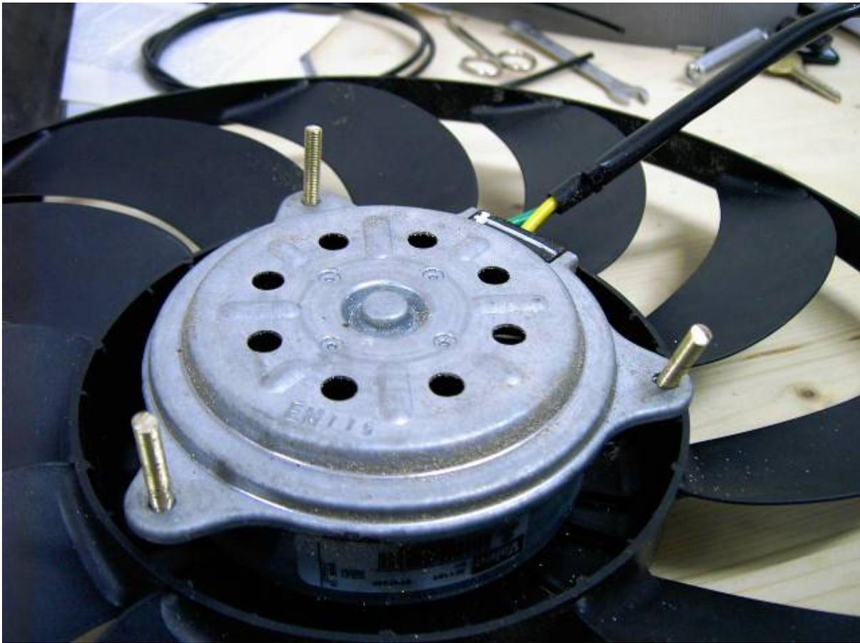
E-Lüfter aus dem VW Touareg, dieser wird mit 3 Schrauben auf die Metallplatte geschraubt
